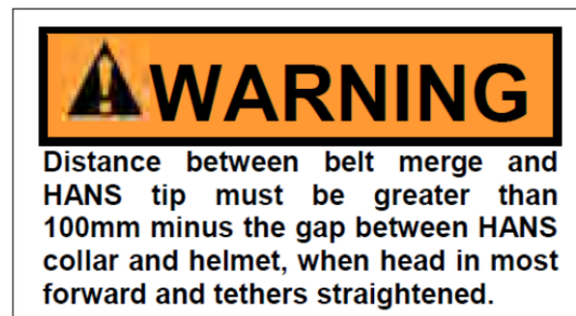
Figura III – Etichetta specifica per le cinghie delle spalle doppie
