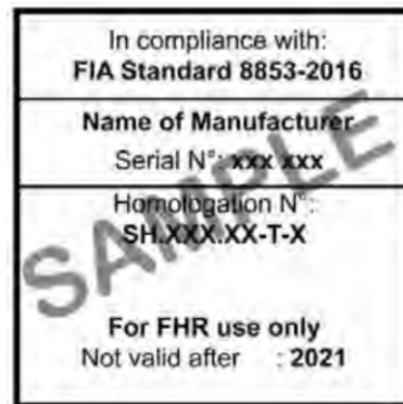
Figura II.b – Etichetta di identificazione per cintura di sicurezza da utilizzarsi con il dispositivo FHR
